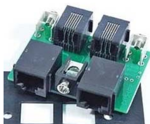
BUS UTP (Universal Throttle Panel) avec prises RJ-12 en face avant
